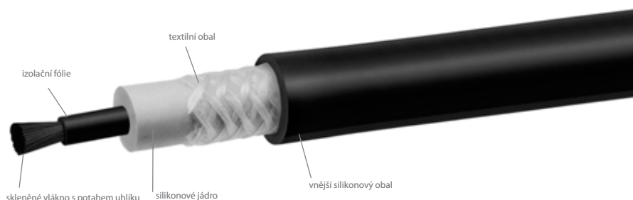
Současná konstrukce uhlíkových zapalovacích kabelů
