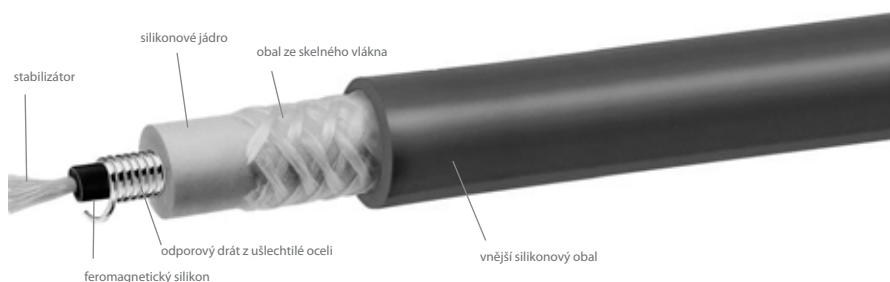
Současná konstrukce reaktčního zapalovacího kabelu
