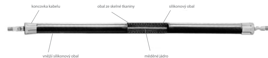
Současná konstrukce kabelu zapalování s měděným jádrem
