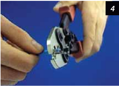
Obr. 4. Pomocí kleští spojíme pevně koncovku s kabelem
