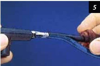
Obr. 5. Pomocí konektorového vypichováku nasazujeme kabel s koncovkou do koncovky zapalování
