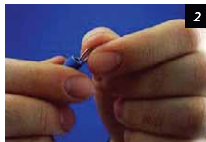
Obr. 2. Pro některé koncovky je nutné vložit spojovací konektor ve tvaru nepravidelného U (propojuje jádro s vnější izolací kabelu)
