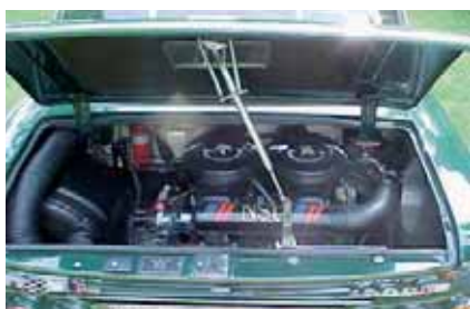
Systém dvojnásobného větráku vzduchem chlazeného motoru NSU
