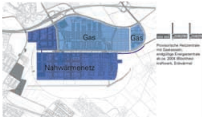
Abb. 1 Energieversorgung Messestadt Riem
